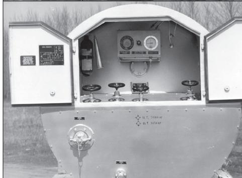
***Емкости для хранения и перевозки жидких криогенных продуктов (азот, кислород, аргон)***
