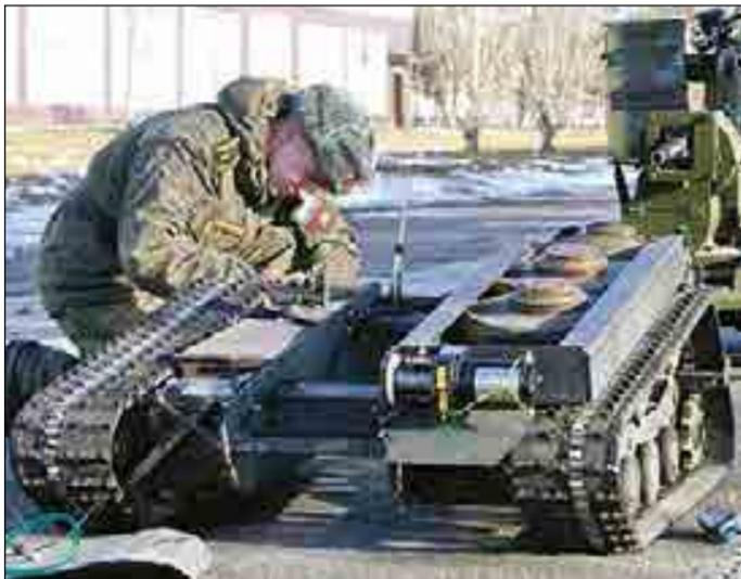
который создал робототехнический комплекс технической разведки, способный дистанционно выполнять обширный спектр боевых задач. Установка оснащена видеокамерами, манипулятором, пулеметом, а также прицепом для эвакуации раненых.
