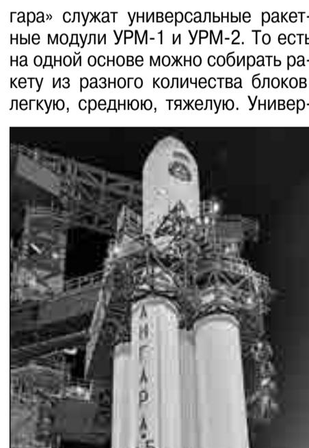
ская ракетный модуль представляет собой законченную конструкцию, состоящую из баков окислителя и горючего, соединенных приводом, и двигательного отсека. УРМ-1 оснащается жидкостным реактивным двигателем РД-191, УРМ-2 – двигателем РД-0124А.
