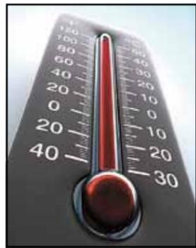
В Европе принято измерять температуру в градусах «по Цельсию». Эта система основана на физических свойствах воды: при нуле градусов она переходит в твердое состояние – замерзает, при 100° – в газообразное.
